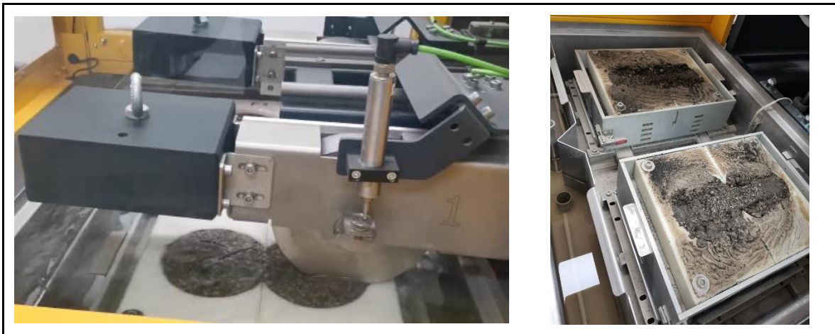
Figura 9. Ensaye RCH y su resultado en muestras de mezcla BAE
